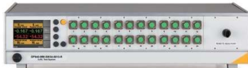
OP940-SW MPO用IL/RL同時測定器 24チャンネル、IL/RLの2波長を40秒以内に測定。
